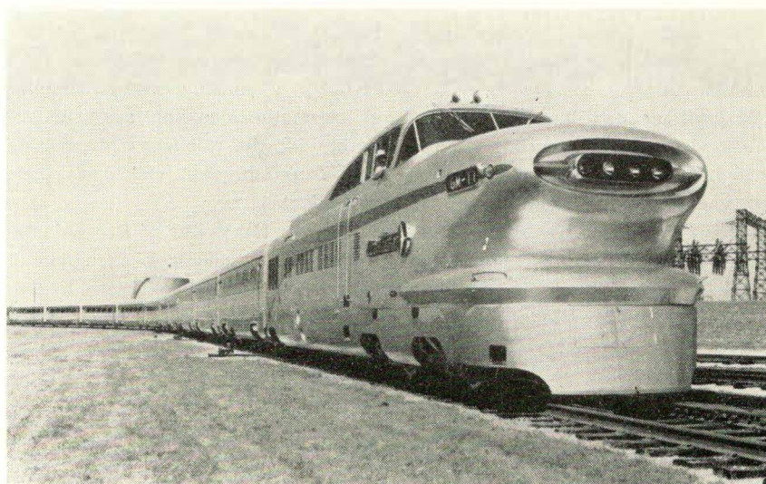
Moderne amerikansk lyntog af meget let specialkonstruktion, vejende mindre end 18 t pr. vogn. Vognene er udviklet af standardrutebiler uden motorer, idet vognstammen i det foreliggende tilfælde trækkes af et letvægtslokomotiv, som imidlertid ikke er særlig let. Lignende tog, men udstyret med svære rutebieldieselmotorer, hvorved adhæsionsvægten vil udgøre omkring halvdelen af totalvægten, kunne sikkert befare en bro over Østre Rende, der udføres med stigninger og styrkeforhold omtrent som en vejbro, men med et enkelt jernbanespor ved siden af vejkørebanen.
